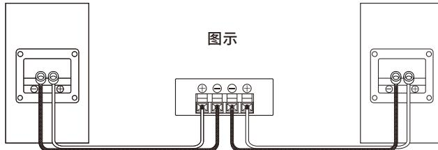
如果左右极性没有正确连接好，那它产生的声感及声音重放效果将会受到极大的影响。
